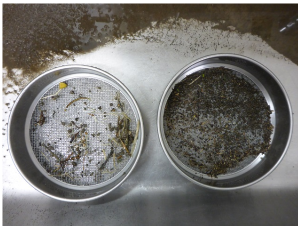
Abbildung 2: links: 2 mm und 1 mm Siebrückstand einer aufgeschlammten Bodenprobe; rechts: Bildaufnahme der gesammelten Kunststofffragmente eines Quadratmeters auf definierter Fläche zur Ermittlung der Flächensumme
