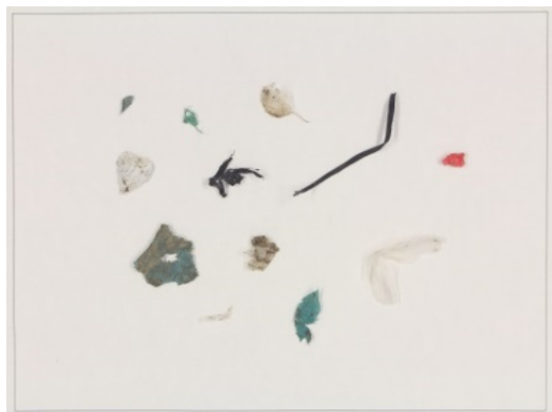
Abbildung 2: links: 2 mm und 1 mm Siebrückstand einer aufgeschlammten Bodenprobe; rechts: Bildaufnahme der gesammelten Kunststofffragmente eines Quadratmeters auf definierter Fläche zur Ermittlung der Flächensumme
