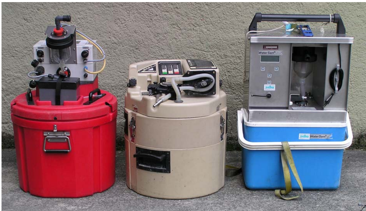
Abbildung 3: Probennehmergeräte mit Vakuumsystem (Außen) und Schlauchquetschpumpe (Mitte)
