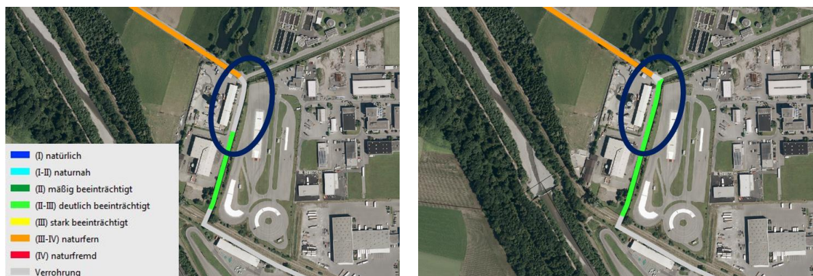
Abbildung 1: Ausgewiesener Projektabschnitt vor (links) und nach (rechts) erfolgter Revitalisierung mit Darstellung des Strukturzustands. © WIS Vorarlberg
