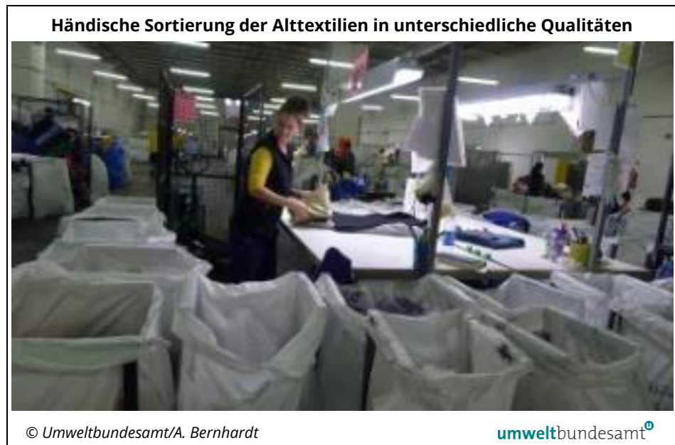
Abbildung 63: Händische Sortierung der Alttextilien in unter- schiedliche Qualitäten
