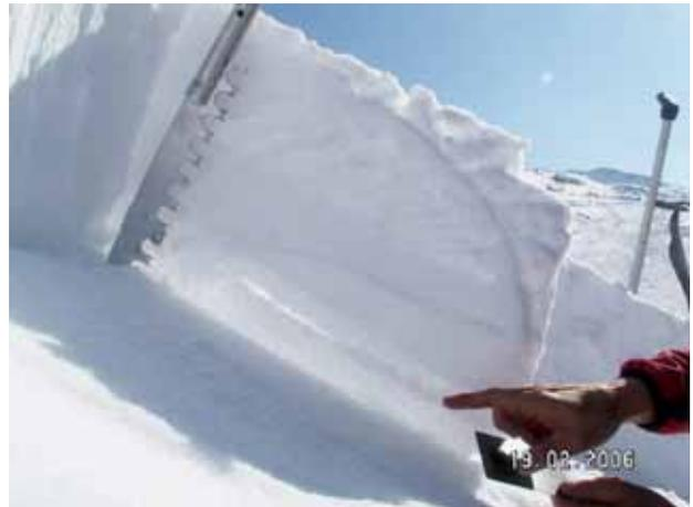
Aus dem Schneeprofil im Anrissbereich ergab sich eine kantige, weiche Schicht als Schwachschicht und die markante Harschschicht als Gleitfläche. Rechts im Bild sind die unterschiedlichen Schichtungen erkennbar.
